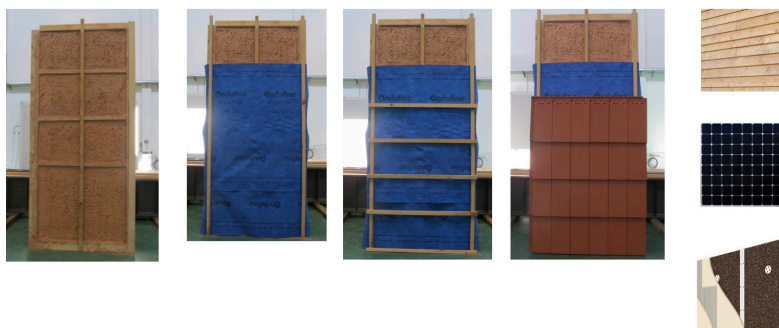
Figura 4 Ensaio de montagem de revestimentos.
